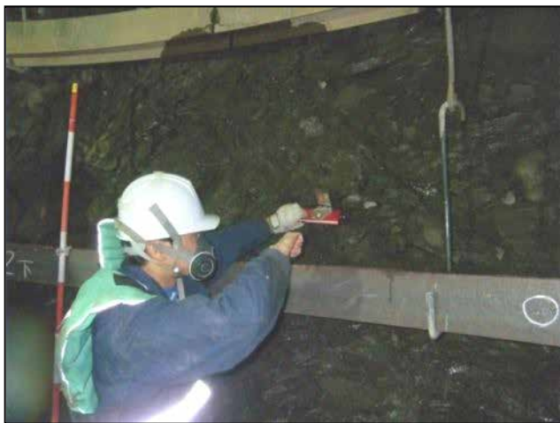
坑道壁面の地質観察の様子 (換気立坑深度339m)
