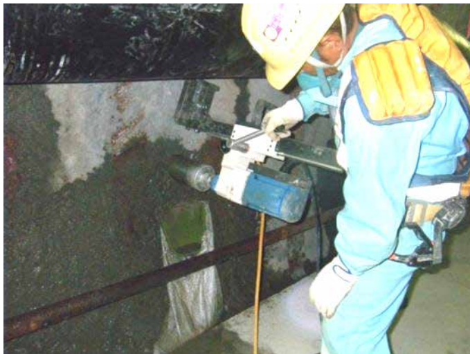
コンクリート材料の影響を把握するための調査（250m調査坑道）
