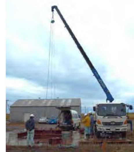
産業技術総合研究所-原子力機構 共同研究 既設ボーリング孔を用いた物理検層の様子 (平成23年10月、於浜里地区)
