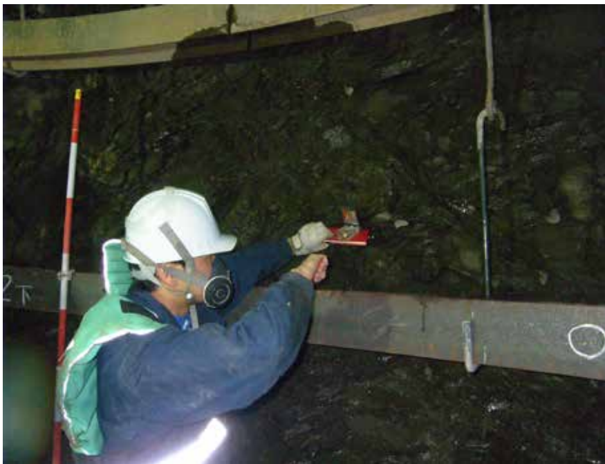
坑道壁面の地質観察の様子（換気立坑深度339m）
