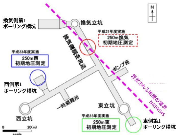
図 14 初期地圧測定の実施位置（250m調査坑道）
