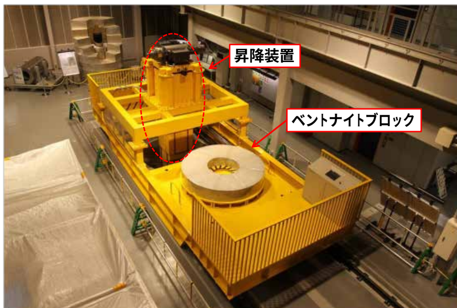
写真 2 緩衝材定置試験設備の製作状況
