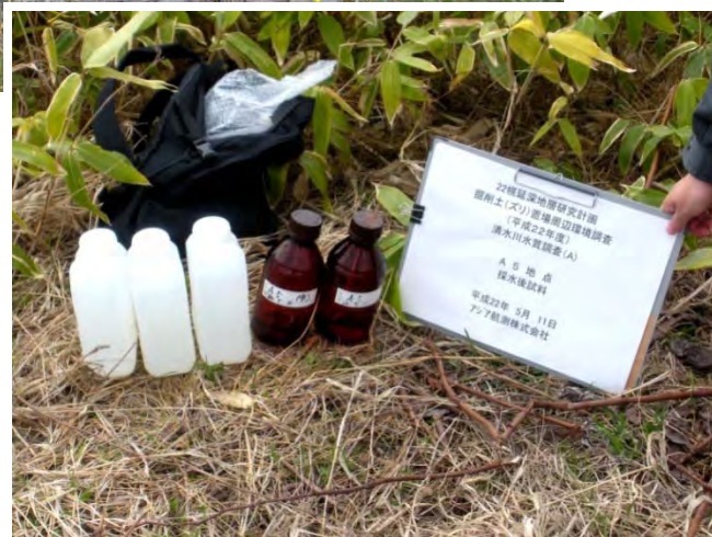
掘削土(ズリ)置場周辺の地下水 (A1~A4)、清水川(A5、A7)、雨水調整池(A6)の採取状況
