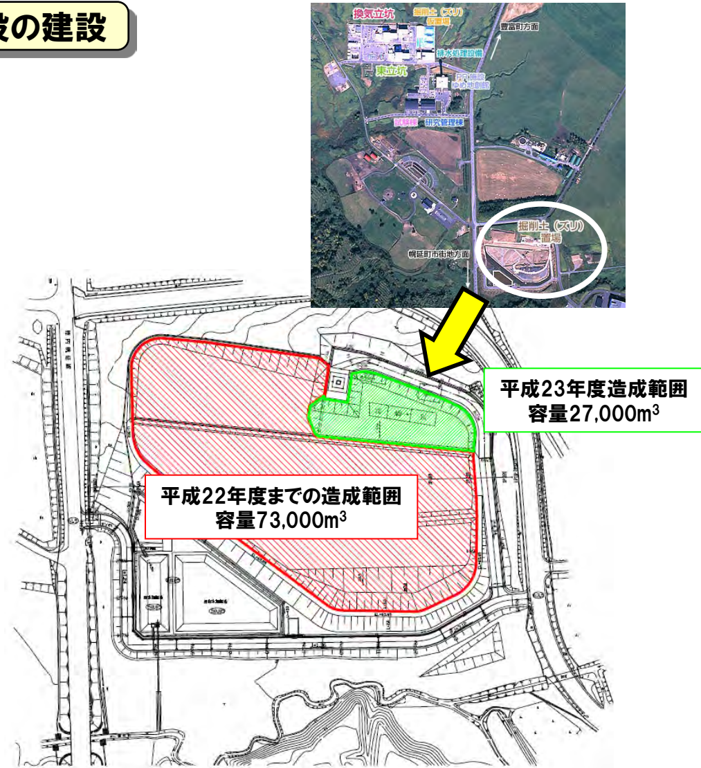
掘削土(ズリ)置場の拡張
