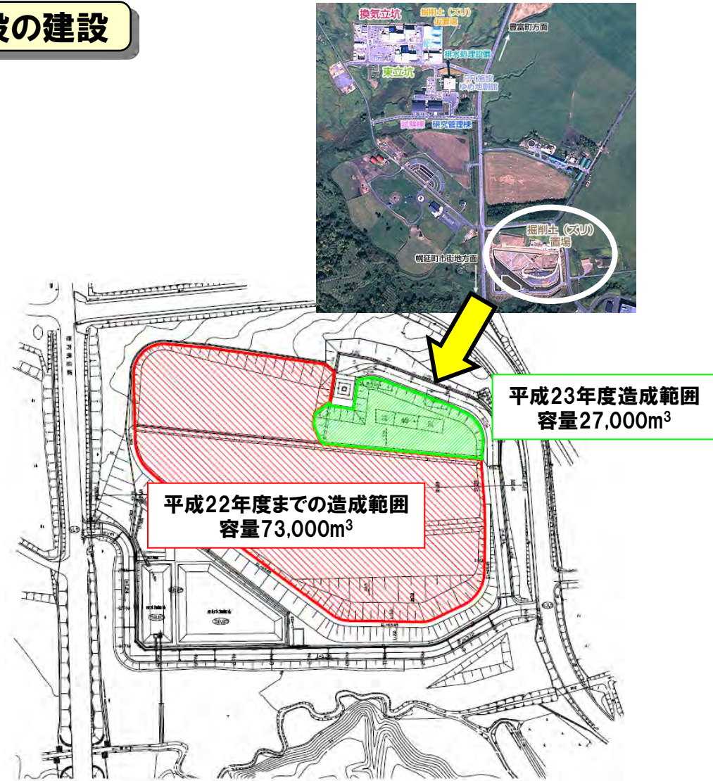
掘削土(ズリ)置場の拡張
