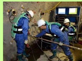
地層科学研究 (坑道掘削影響試験)
