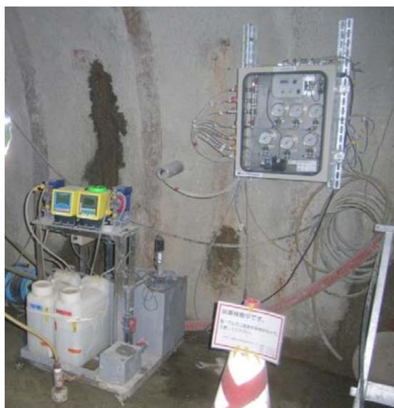
図 28 還元環境回復能力に関わる調査試験装置の一例 (250m調査坑道)
