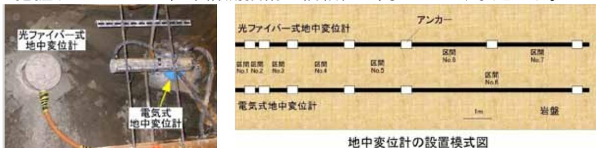
図 41 地中変位計の設置状況（設置当時）
