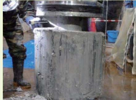
人工バリア性能確認試験の解体調査（イメージ）
