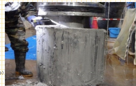
人工バリア性能確認試験の解体調査のイメージ
