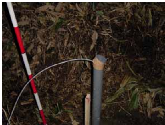
簡易ボーリング孔を利用したガス測定の例
