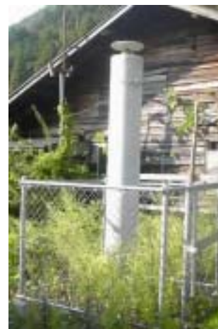
GPS 観測装置の設置の例
