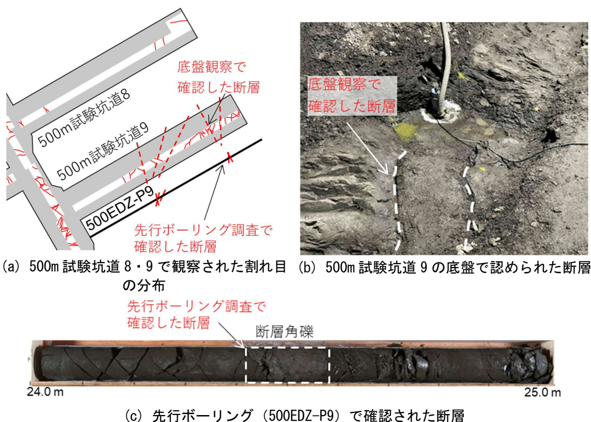
図 19 500m 試験坑道 9 における地質調査の結果の例
