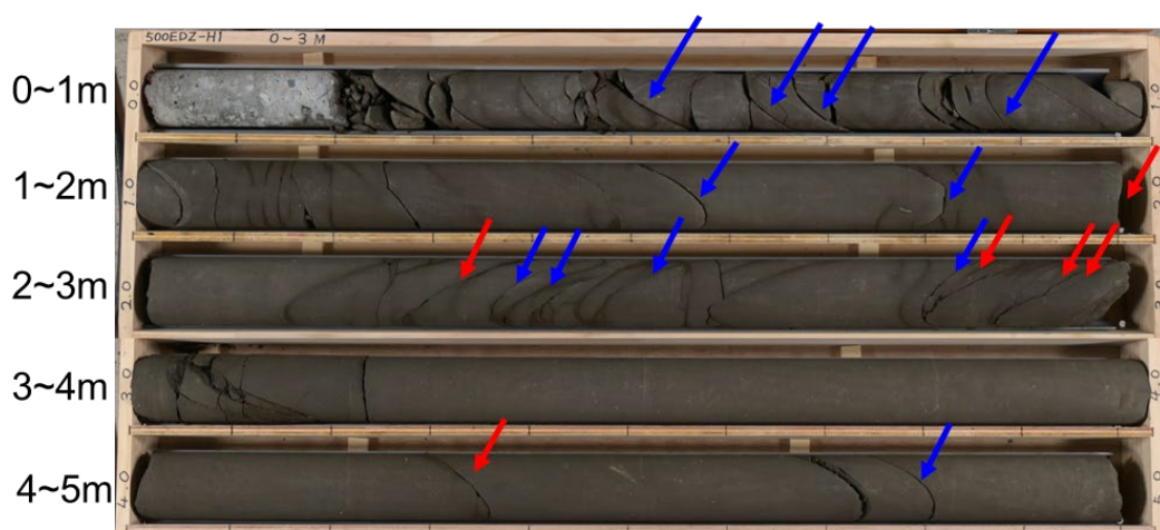
図 29 透水試験孔で得られたボーリングコアの写真（孔口から 5 m まで） 図中の矢印は、BTV 調査により確認された割れ目の確認位置を示しています。なお、青色矢印は引張割れ目、赤色矢印はせん断割れ目を示しています。
