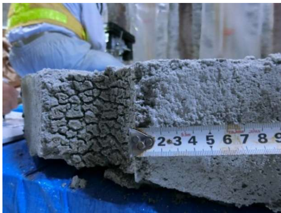
(a) ヒーター接触部に認められた 緩衝材ブロックのひび割れ
