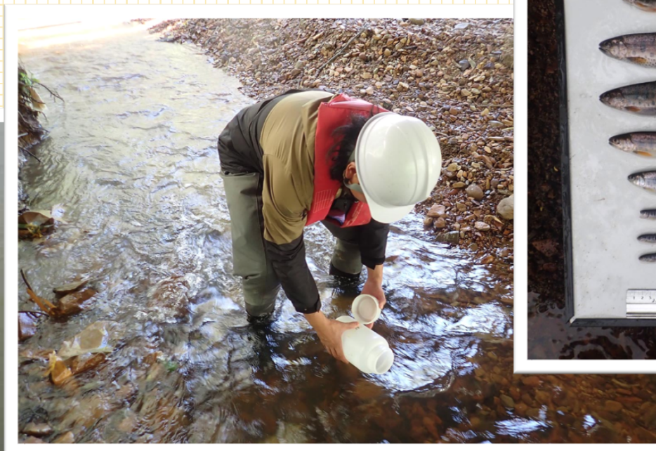
掘削土(ズリ)置場周辺の地下水の採水状況
