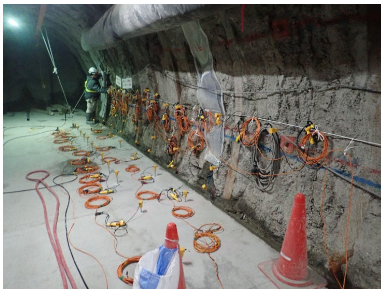
図 18 試験坑道 6 における弾性波トモグラフィの実施状況
