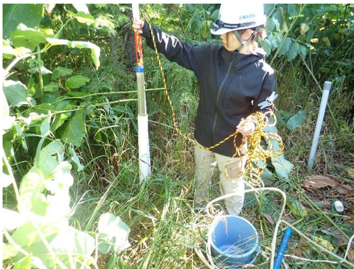
掘削土(ズリ)置場周辺環境調査 地下水採水状況
