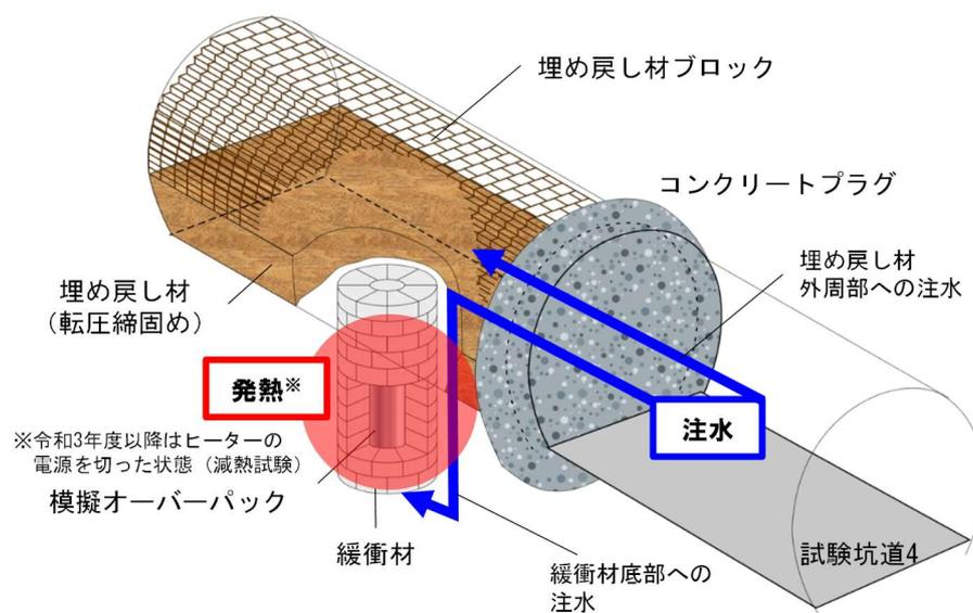
図7 人工バリア性能確認試験の概念図
