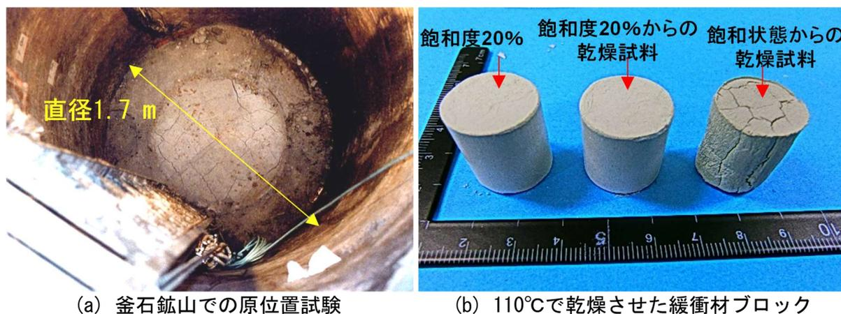
図 21 これまでの室内・原位置試験で確認された、100℃以上の温度で加熱された緩衝材に発生したひび割れ
