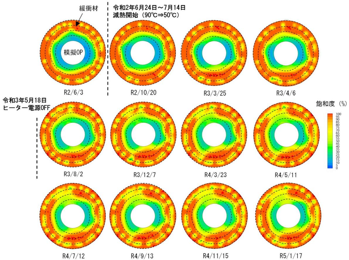
(c) 比抵抗※トモグラフィによる緩衝材の飽和度の算出結果
