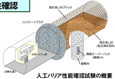
人工バリア性能確認試験の概要
