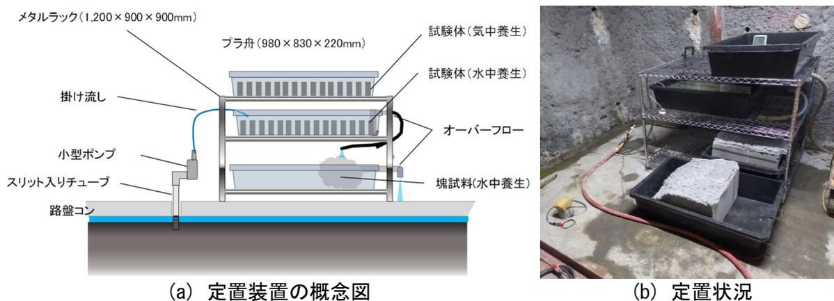
図 15 コンクリート試験体の暴露試験
