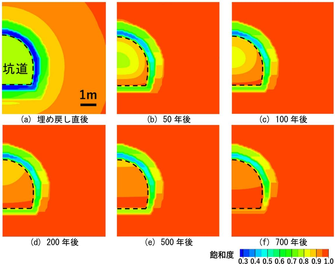
図 17 坑道埋め戻し後の飽和度変化
