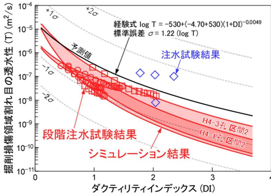
図 29 注水試験結果と DI モデルの比較
