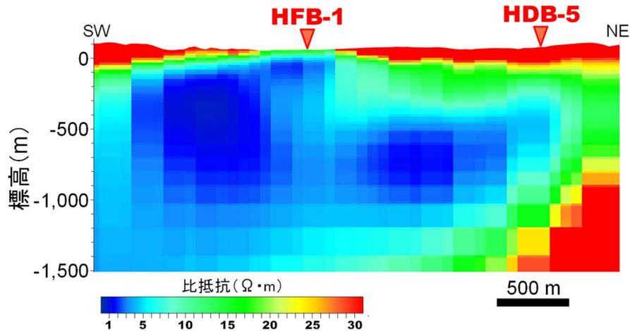
図 26 令和 2 年度の電磁探査で得られた比抵抗分布（99 測点、拘束なしの解析結果、HFB-1 孔および HDB-5 孔を通過する鉛直断面図）<sup>(8)</sup>
