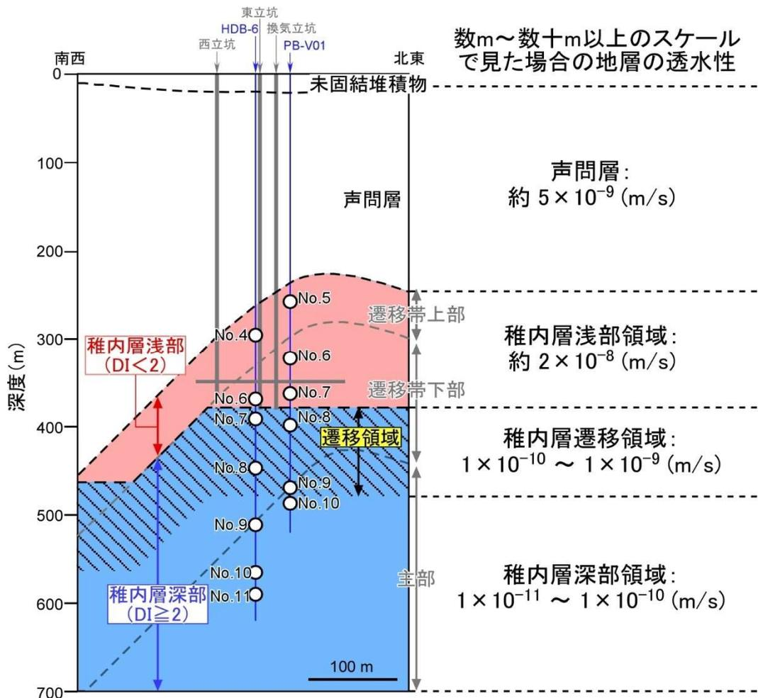
図 24 地下施設建設時の地下施設周辺のボーリング孔（HDB-6 孔および PB-V01 孔）での水圧変化から数値解析により推定された各地層の数 m～数十 m 以上のスケールで見た場合の透水性<sup>(2)</sup>
