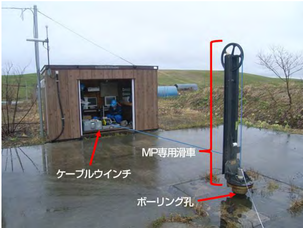
観測装置の回収・挿入時の様子
