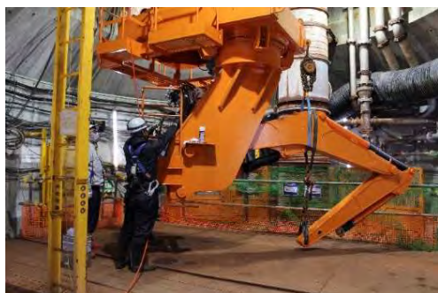
積込機の整備
