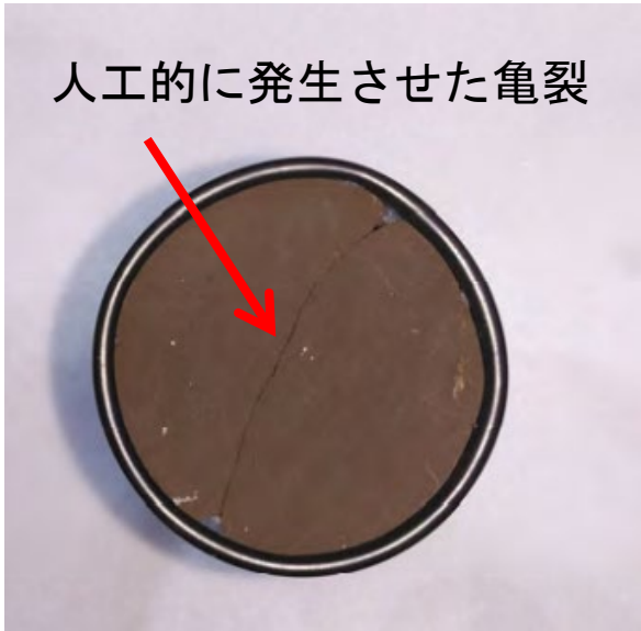
(a) 人工的に亀裂を発生させた岩石コア試料
