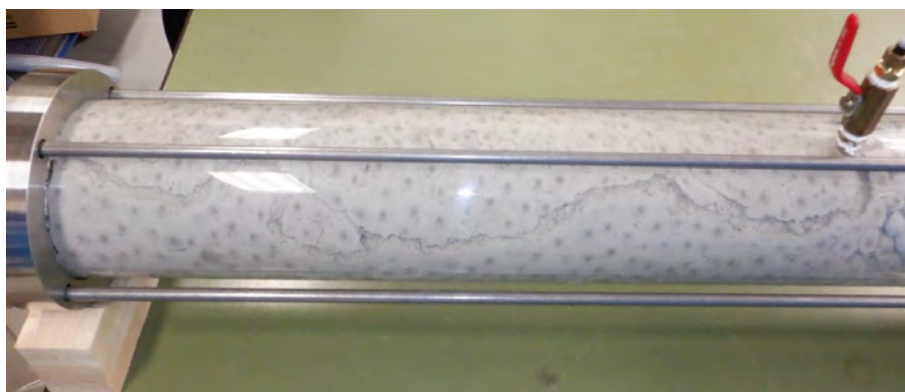
図 46 水みちの発生状況 (13)
