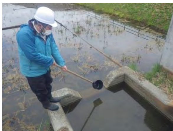
(b) 雨水調整池での採水状況
