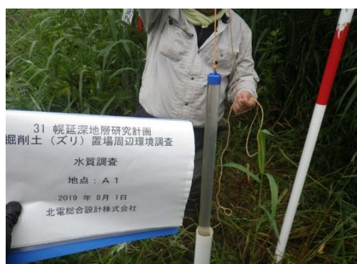
写真 13 掘削土（ズリ）置場周辺の地下水の採水状況（A1～A4）
