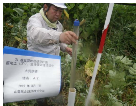
写真 13 掘削土（ズリ）置場周辺の地下水の採水状況（A1～A4）
