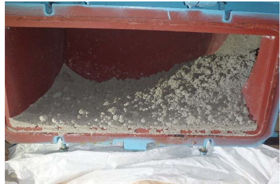
写真 5 吸引機の外観と、捕集した充填材
