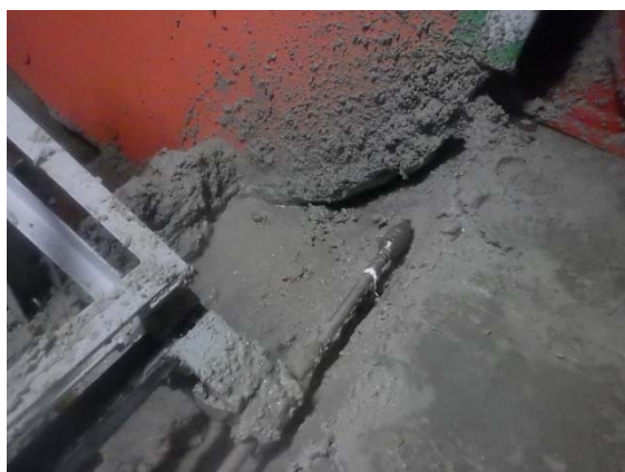
写真 7 除去試験の様子と、除去後の隙間
