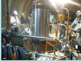
地層処分研究開発 (オーバーパック腐食試験)
