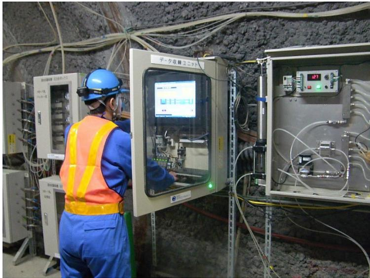
地下水の水圧・水質連続モニタリングの様子
