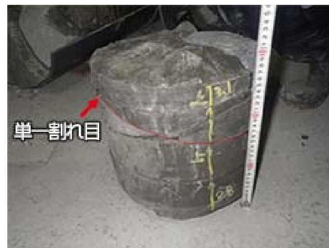
試験後の採取した岩石試料
