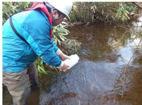
写真 47 清水川の採水状況
