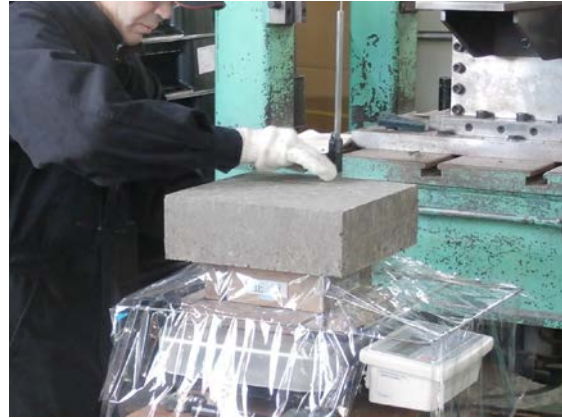
(b) 製作した埋め戻し材ブロック
