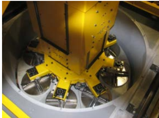
(3) 模擬処分孔へ緩衝材ブロックを降下
