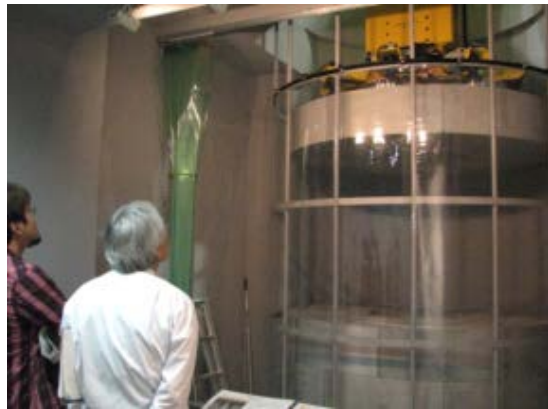
(4) 模擬処分孔へ緩衝材ブロックを降下、定置
