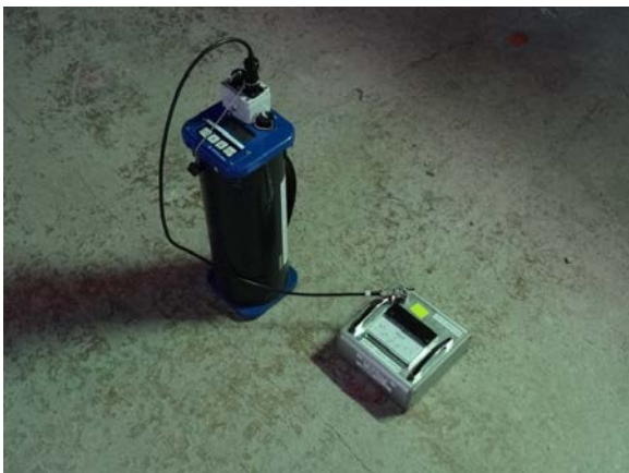
写真 8 ポータブル受信機とレベルメーター (第2回目受信用)
