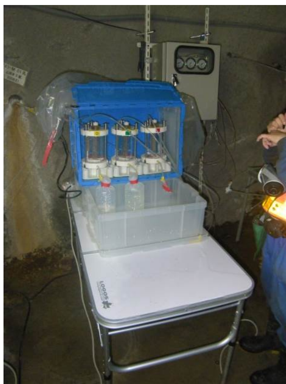
写真1 地下水をろ過するための機器
