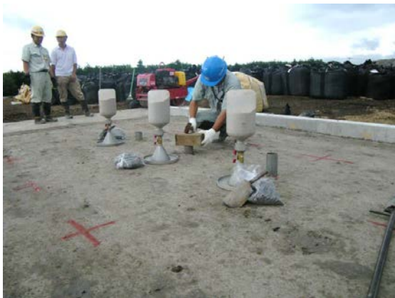
(c) 密度の確認(砂置換法)
