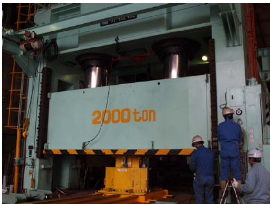
(a) 緩衝材ブロックの圧縮成形
