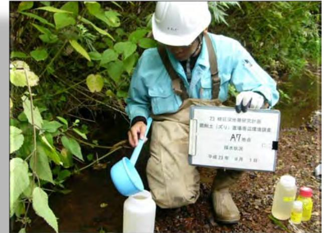
掘削土（ズリ）置場周辺及び河川水の水質調査
