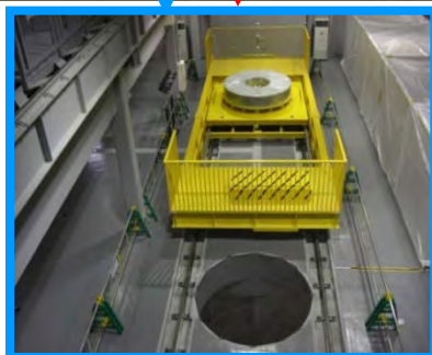
平成21年度、22年度製作 緩衝材定置装置走行台車・緩衝材台車
