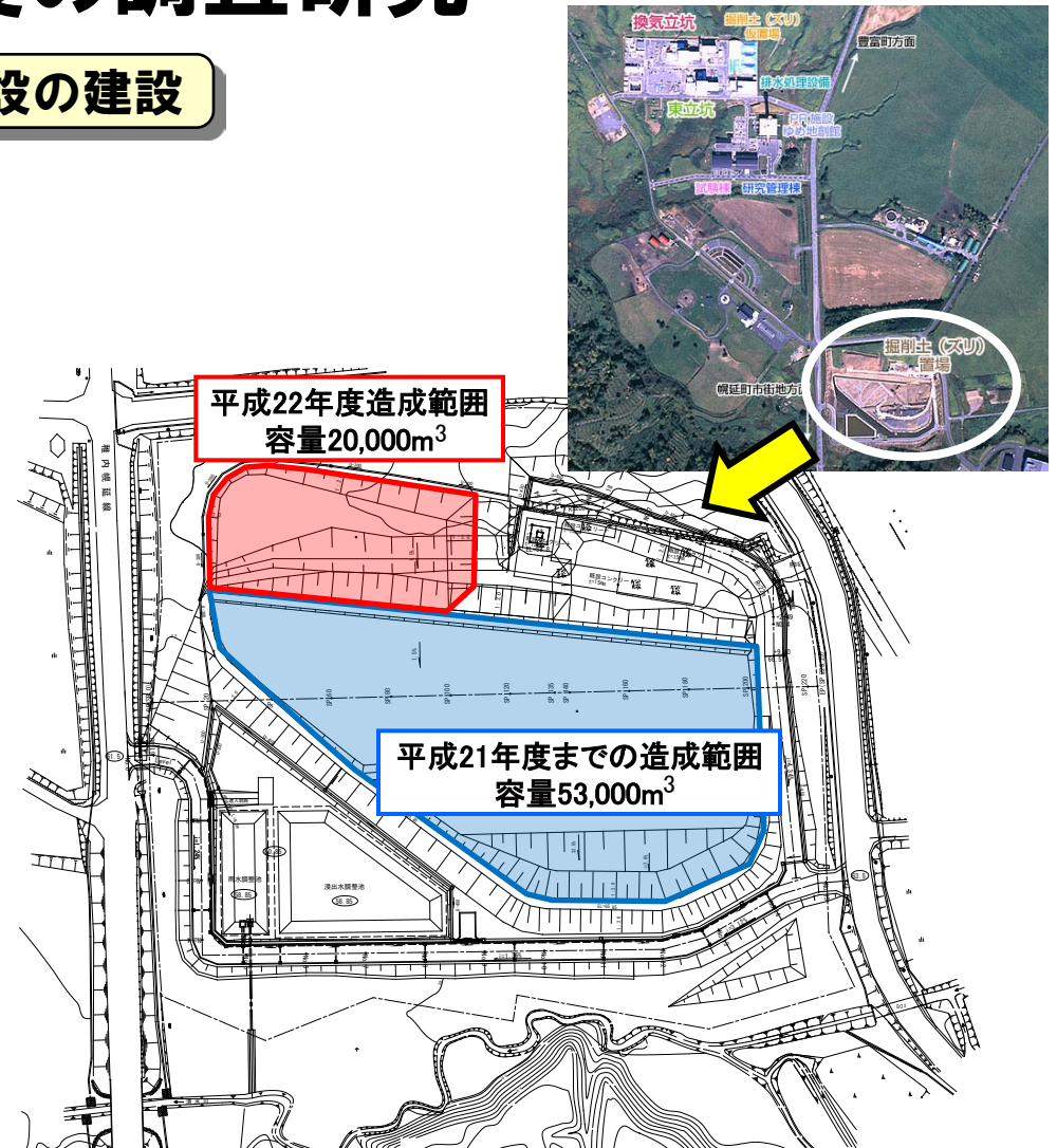
掘削土(ズリ)置場の拡張
