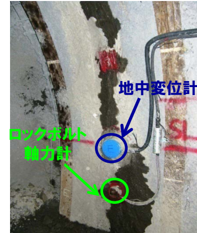
計測機器設置状況 (140m調査坑道の例)
