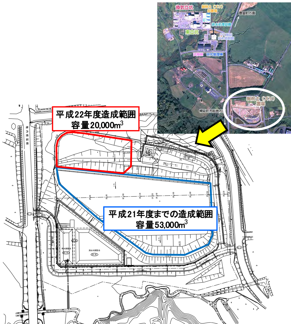
掘削土(ズリ)置場の拡張
