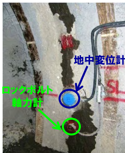
計測機器配置図（上）および計測機器設置状況（下）
