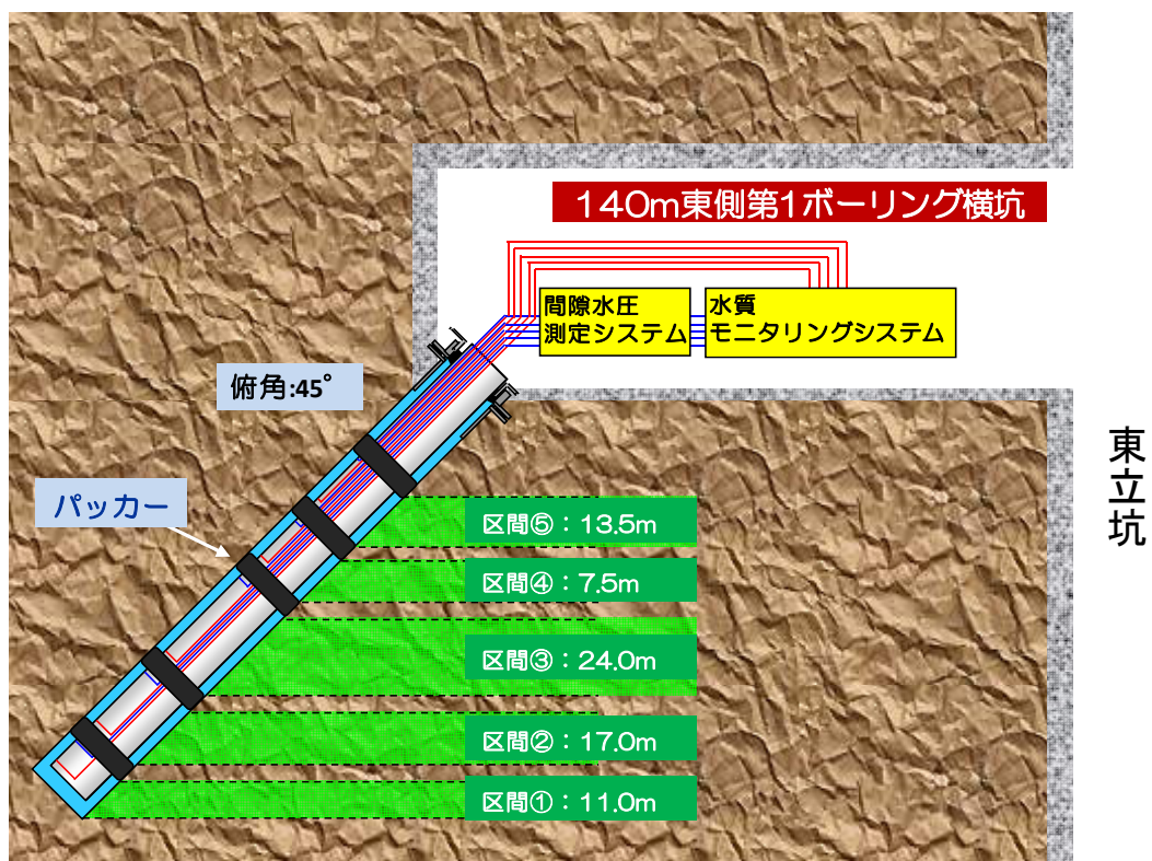
図4 地下水の間隙水圧・水質モニタリング装置の概要
