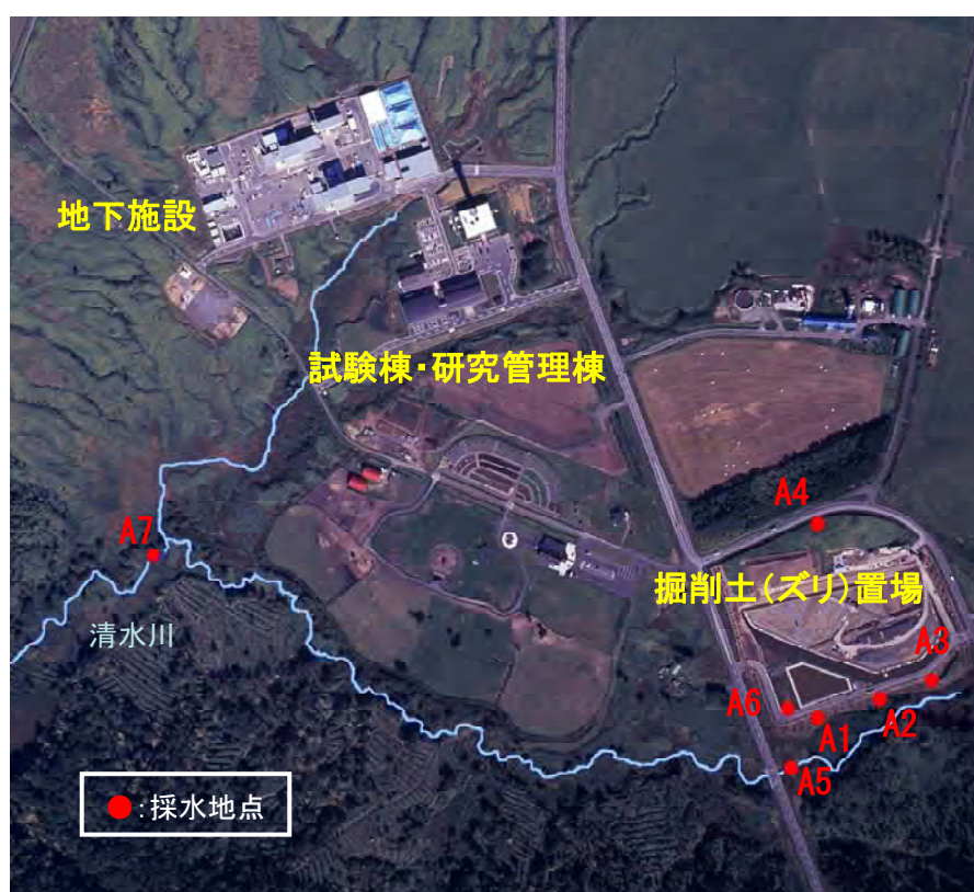
掘削土（ズリ）置場・清水川における水質モニタリング調査位置
