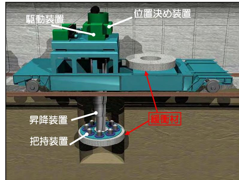
緩衝材定置試験設備の概念図
