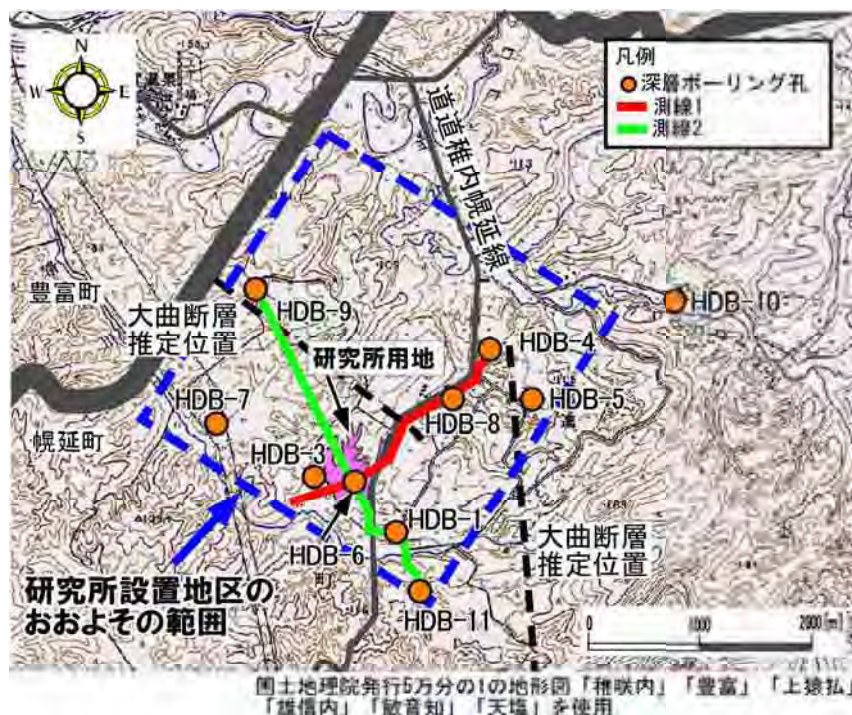
図 32 電気探査の測線配置
