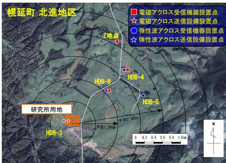
遠隔監視システムの設置点
