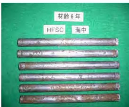
図 45 鉄筋の腐食状況（HFSC）
