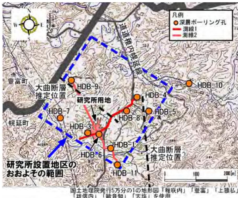
図 28 電気探査の測線配置
