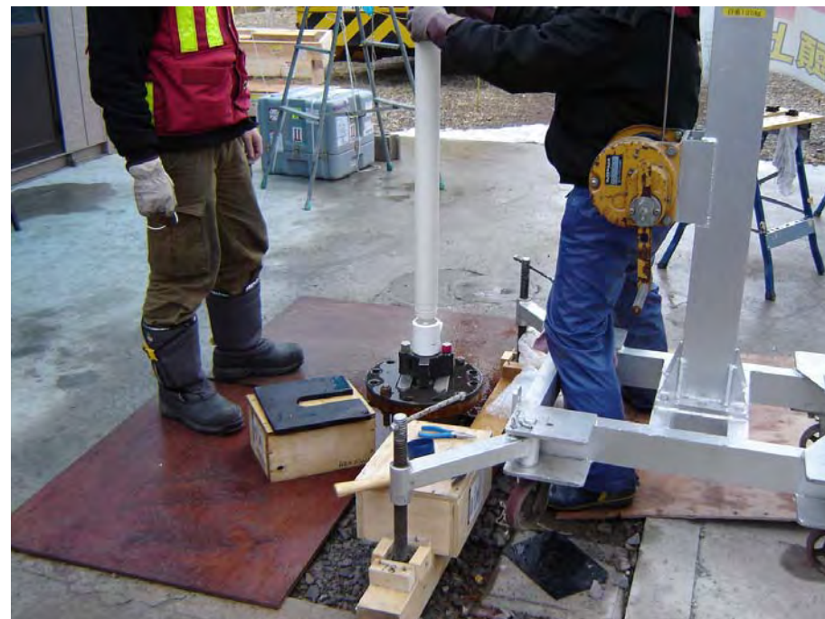
HDB-11孔での地下水の水圧・水質 長期観測装置の設置作業の様子
