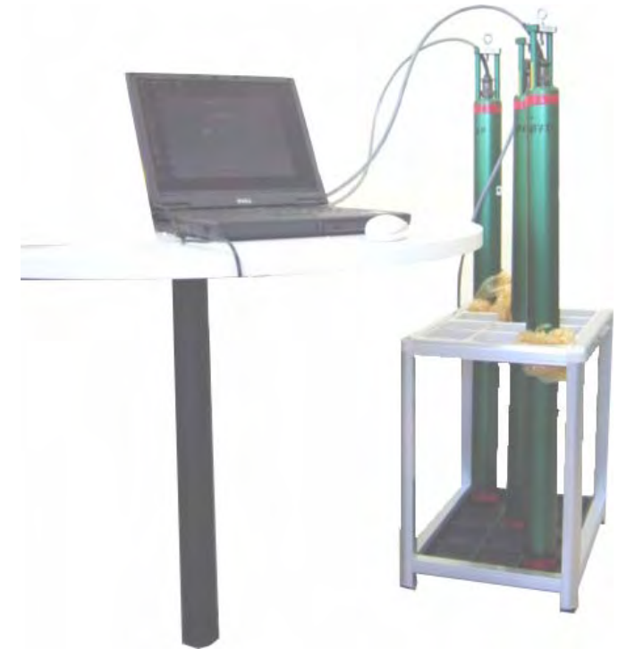
地下施設周辺に設置する 高精度傾斜計
