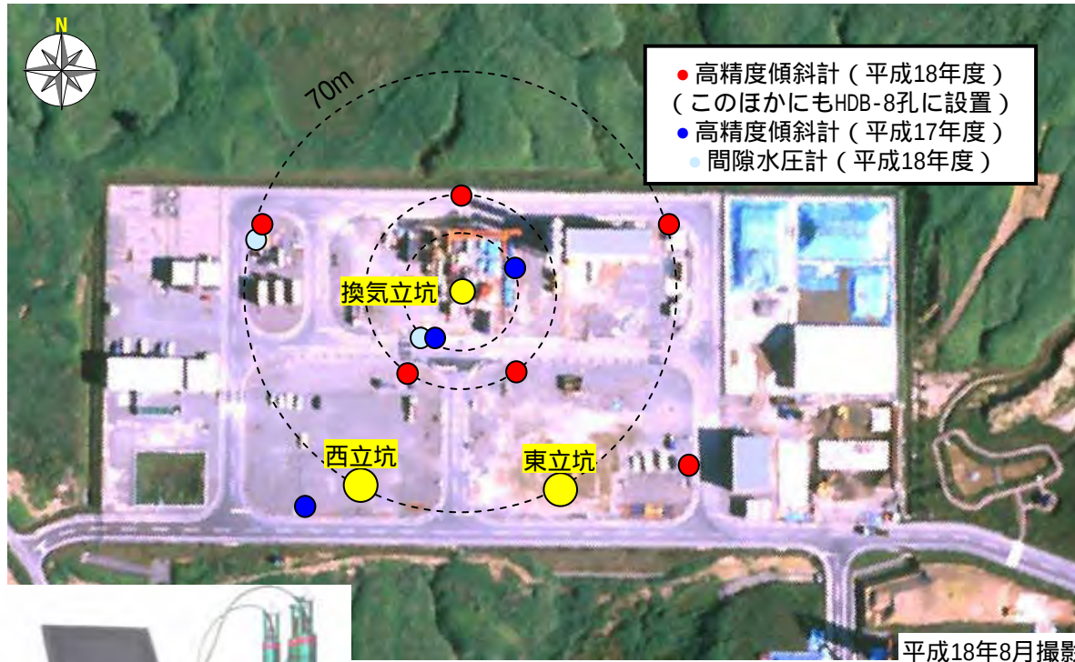
地下施設周辺の傾斜計設置位置
