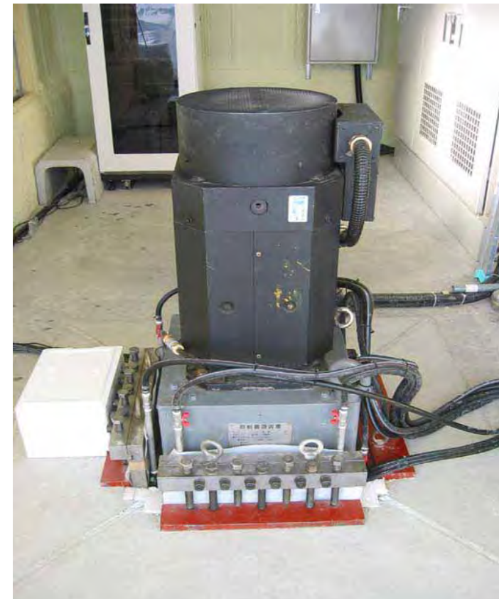
地震波の送信ユニット (HDB-3孔敷地内に設置した送信ユニット)
