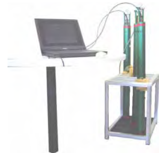
地下施設周辺に設置する高精度傾斜計
