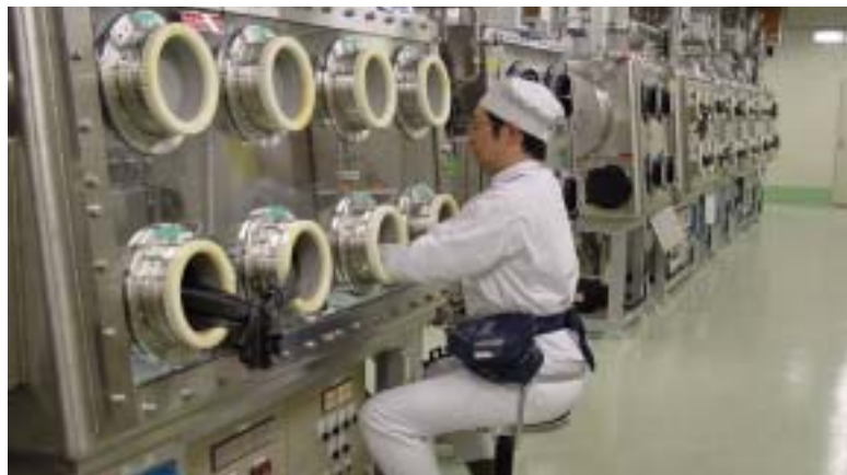
室内での物質移行試験の例 (東海事業所クオリティ)
