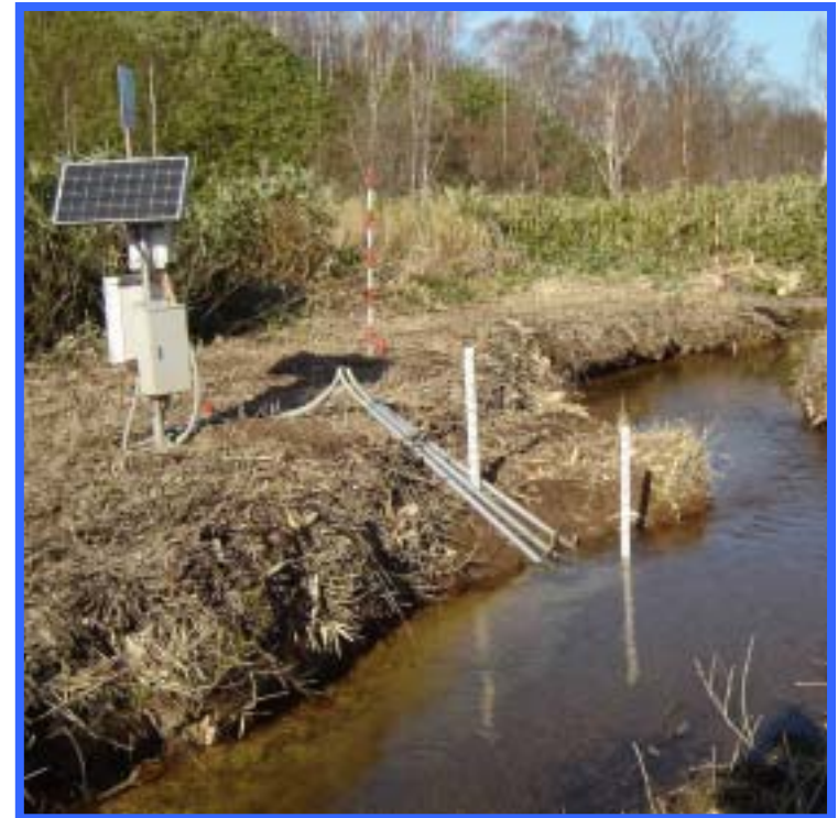
河川流量観測の例
