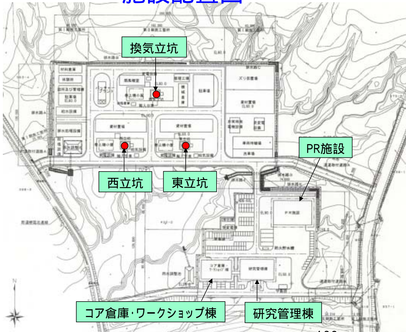
地下施設建設中の配置のイメージ
