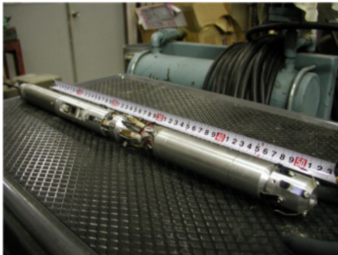
岩盤力学測定装置（孔内部）
