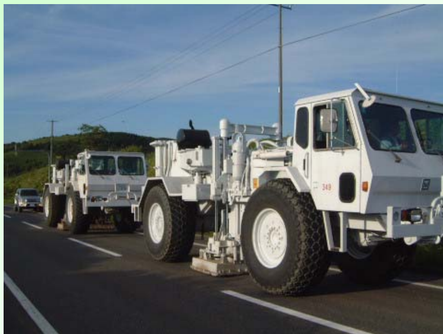
大型バイブプレートによる発振 状況
