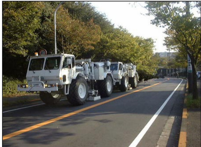
物理探査(反射法地震探査)調査風景
