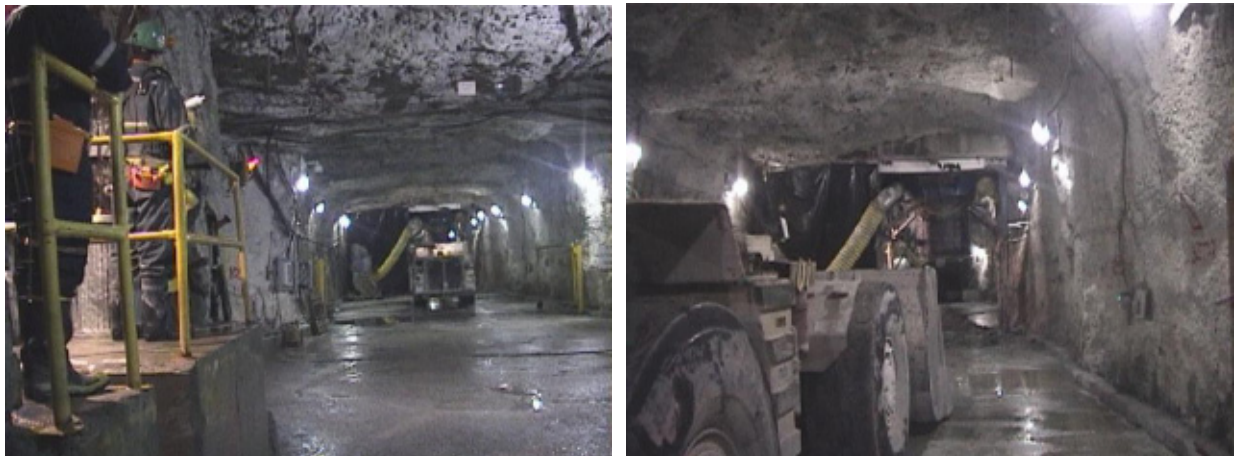
図 31 カナダのウラン鉱山での鉱石運搬装置の遠隔操作 (左；遠隔操作状況、右；遠隔操作される鉱石運搬装置)
