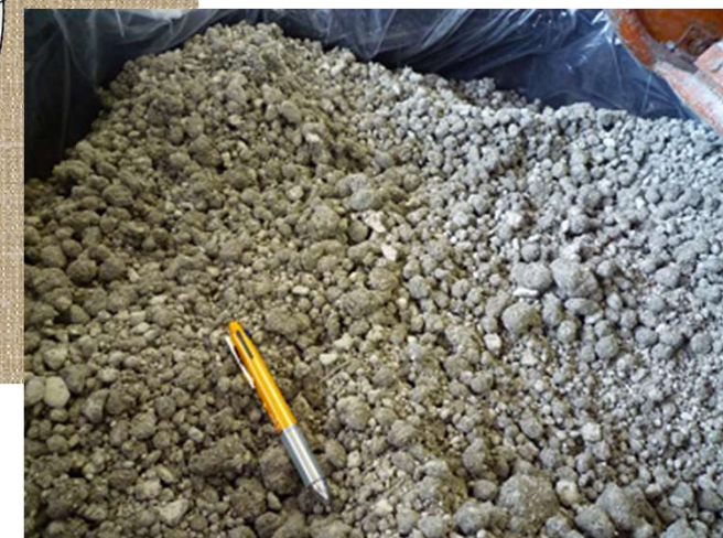
掘削土（ズリ）を用いた埋め戻し材
