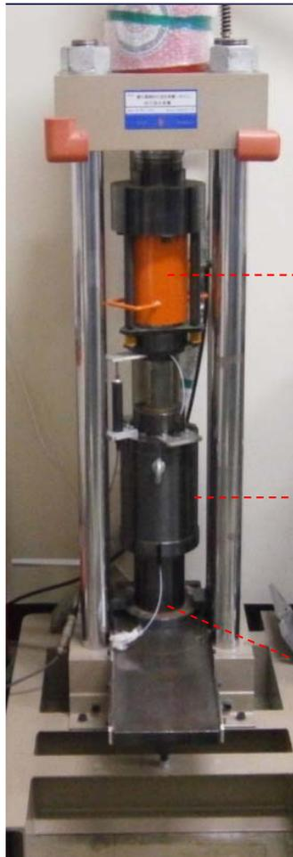
油圧ジャッキで岩石に圧力をかける
