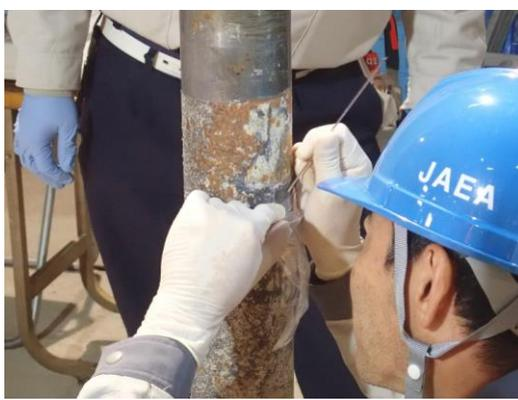
試験体取出し状況(左)と腐食生成物の採取状況(右)
